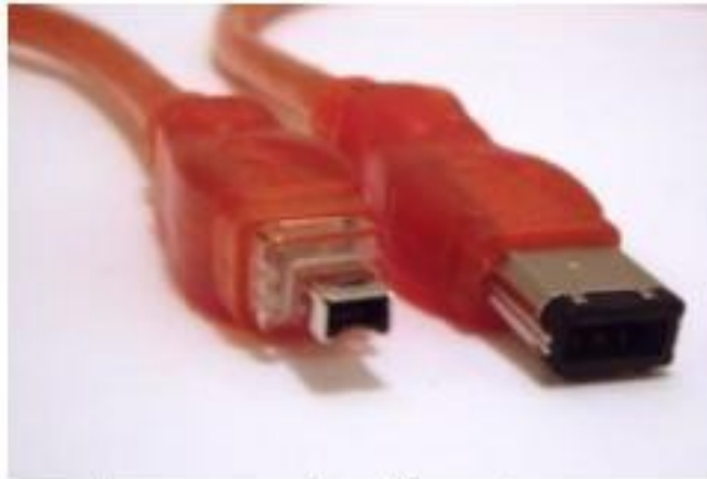
4-pinski (lijevo) i 6-pinski (dsno) FireWire konektori
